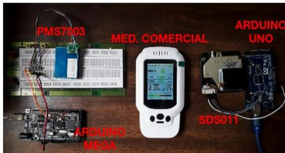
Figura 1: Disposição dos sensores durante o experimento.
